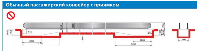
Пассажирский конвейер KONE InnoTrack™ может быть установлен на завершенном и чистовом полу, не требует сооружения приямка и монтируется на любой плоской поверхности.
