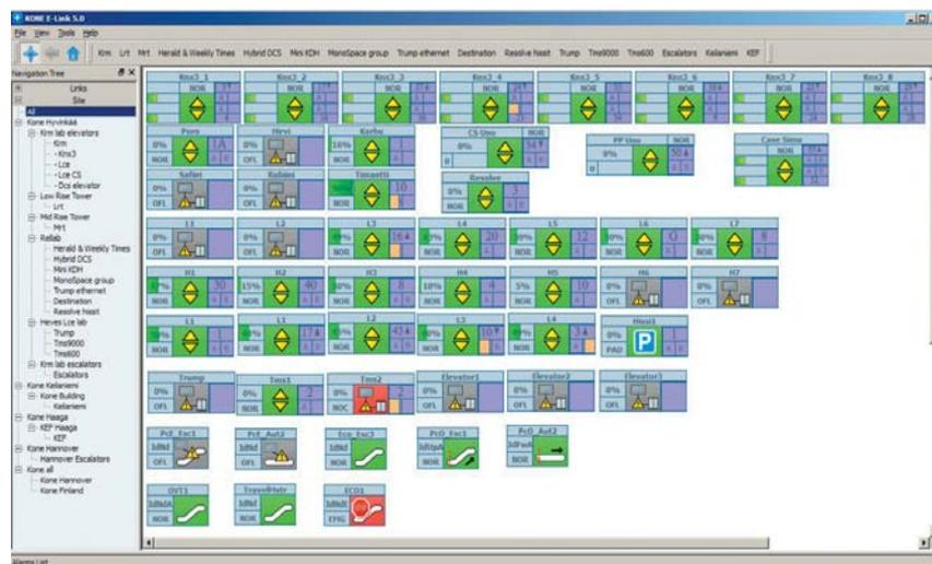
Отчет о мониторинге неисправностей с указанием рабочего состояния каждой единицы оборудования
